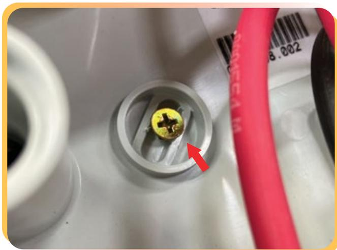
Após escolher o local de fixação, prenda sua TECBOX<sup>®</sup> na superfície utilizando os parafusos enviados no seu Kit de Instalação.
