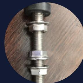
Permite o nivelamento do trilho no "L" Metálico
