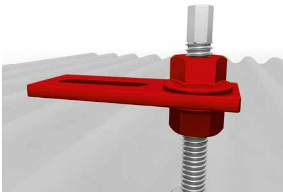
Aparafuse a porca auto-travante sob a placa adaptadora na posição correta para definir a altura. Após o ajuste correto da placa adaptadora, aperte a porca de travamento superior.
