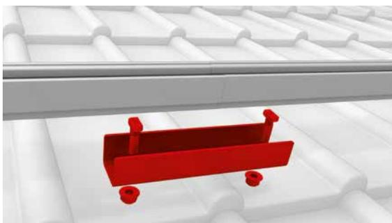
A emenda de trilhos deve ser posicionada sob a junta e fixada com parafusos cabeça de martelo e porcas auto-travantes. A junta não pode estar no alcance dos fixadores do sistema (Hanger Bolts).
