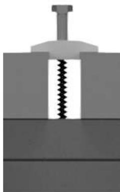
**Atenção:** para garantir a fácil instalação, é importante que o parafuso esteja perpendicular ao perfil. Para que a peça não rotacione, segure a cabeça do grampo e fixe com o torque da parafusadeira adequado.
