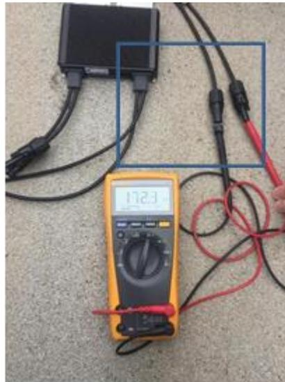
6. **Se não houver falha nos diodos:** Meça a  $V_{oc}$  do(s) módulo(s) e compare com os valores do datasheet (ou da etiqueta de informações técnicas) – uma grande diferença de valores pode indicar um problema no(s) módulo(s) fotovoltaico(s).
