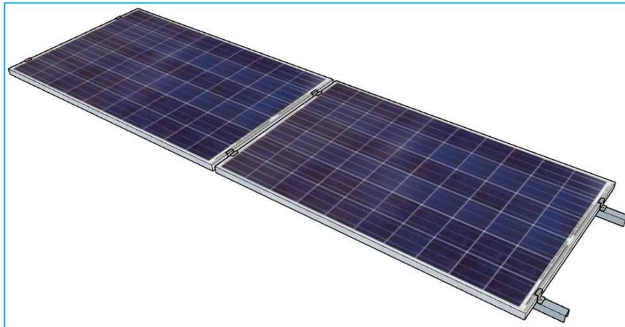
**Figura 20** – Exemplo de instalação pelo Frame Curto.
