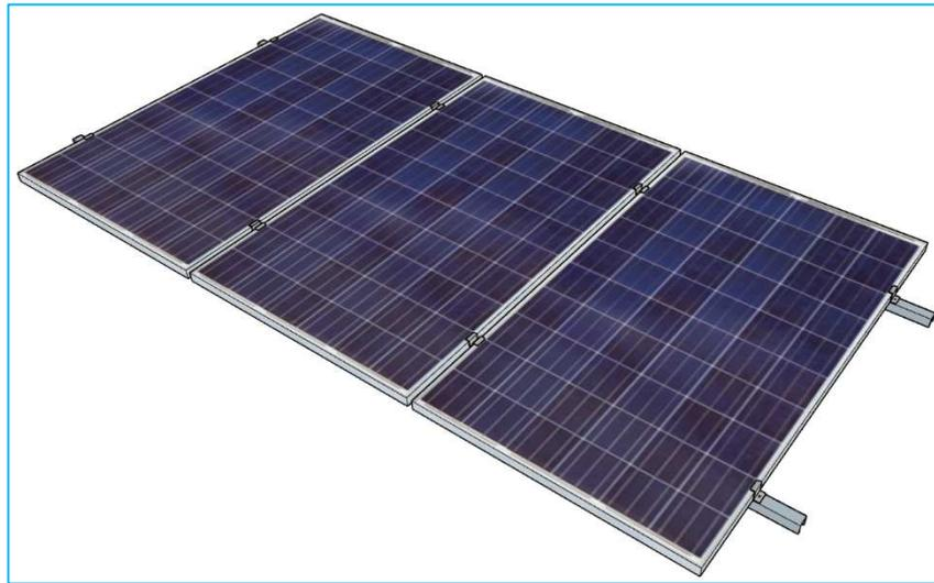
**Figura 17** – Exemplo de instalação pelo Frame Longo.
