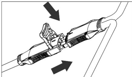
*Interface do conector AC da esquerda para a direita.*
